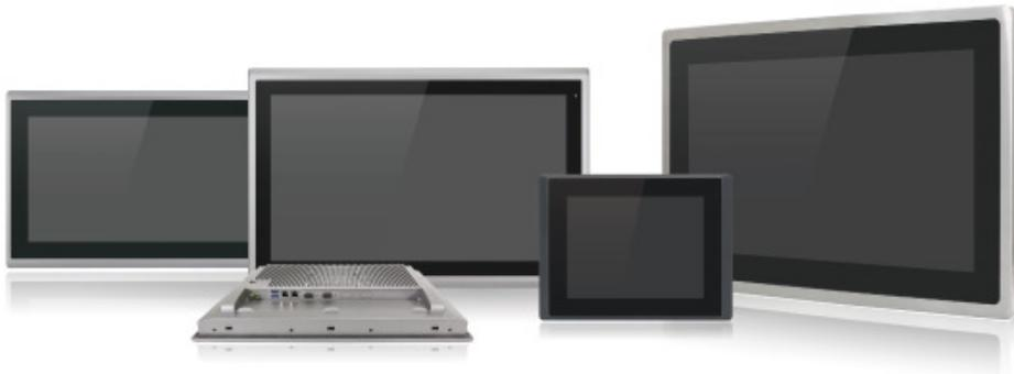
Dank den integrierten PoE-Modulen können Sie sich in Zukunft den Stromanschluss für Ihre Panel-PC's / HMI's von 5" bis 24" sparen. Sie speisen das Gerät ganz einfach über das Netzkabel und machen so Ihre Installation einfacher und schneller.
